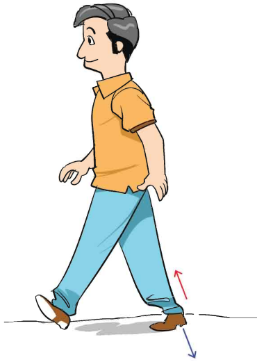
চিত্র ১০.০৩: একজন মানুষ হাঁটার সময় পা দিয়ে যখন মাটিকে ধাক্কা দেয়, তখন মাটিও মানুষটিকে পাল্টা ধাক্কা দেয়।
